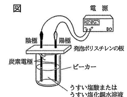
【実験1】ビーカーの中に、溶液としてうすい塩酸を入れて電気分解を行った。
