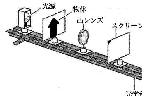
1 図2のように、物体をレンズの焦点距離の2倍となる位置に置いた。スクリーンを動かしたときに、物体と同じ大きさの像ができる位置を図2のアからエまでのなかから1つ選び、記号で答えなさい。また、このときスクリーンに映る像は、実像と虚像のうちどちらか。答えなさい。
